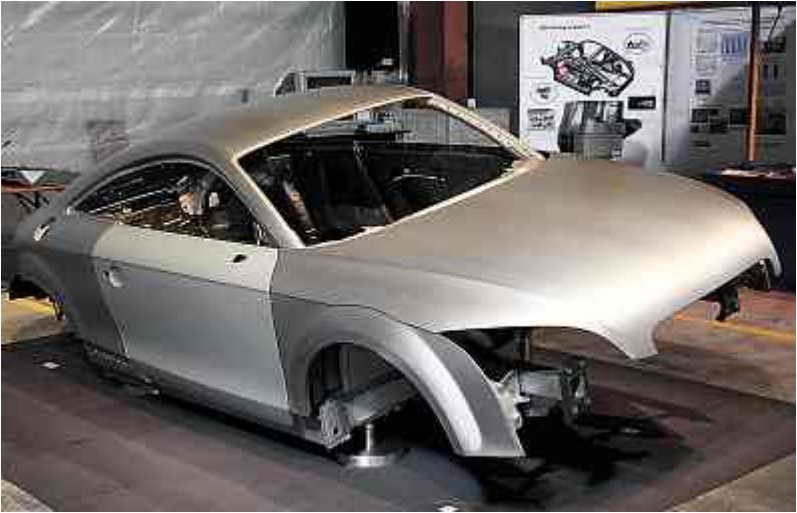
DGS Druckguss System produit des pièces moulées de 10 grammes à 8 kilos et remporte régulièrement des prix. Depuis 2006, il fournit certaines pièces de la structure Space Frame de l’Audi TT. PHOTO D.R.
